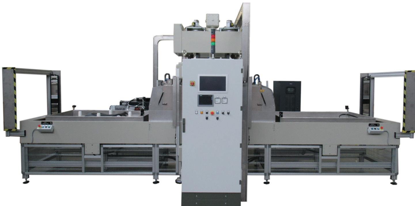
Per la saldatura di loghi (trapuntatura, o loghi in PVC, o loghi in poliestere) su rivestimenti di sedili
